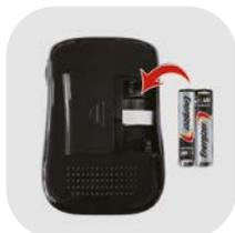
2. Inserte las pilas correctamente de la manera que indican las marcas.
