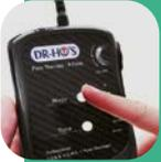
**4** Pulse el selector de Modo para elegir entre los modos A, B o C. Una luz intermitente indicará el modo seleccionado.
